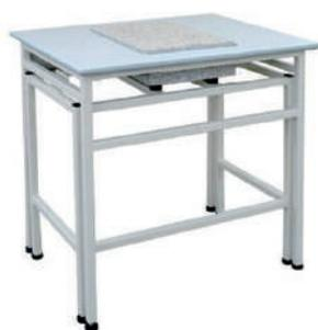
Tavolo anti-vibrazione ideato per avere una postazione di lavoro stabile per una pesatura di massima precisione. La struttura del tavolo assicura l'isolamento da vibrazioni nate dalla normale operatività sulla bilancia stessa. Funzione assicurata separando la struttura su cui poggia la bilancia, resa stabile da un blocco di pietra liscia, e la parte che fa da ripiano per oggetti. Piedini filettati permettono regolazione in altezza.
