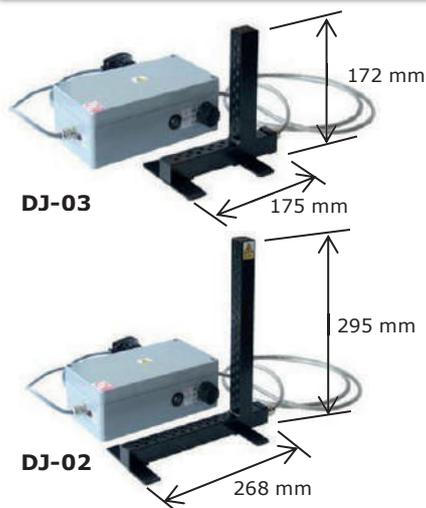
Ionizzatore antistatico utilizzato per rimuovere principalmente l'eccedenza di ioni, ioni negative della parte da pesare come negli oggetti circostanti e nell'attrezzatura. Le cariche elettrostatiche dell'aria sono neutralizzate dando quasi un perfetto bilanciamento tra ioni positivi e negativi.
