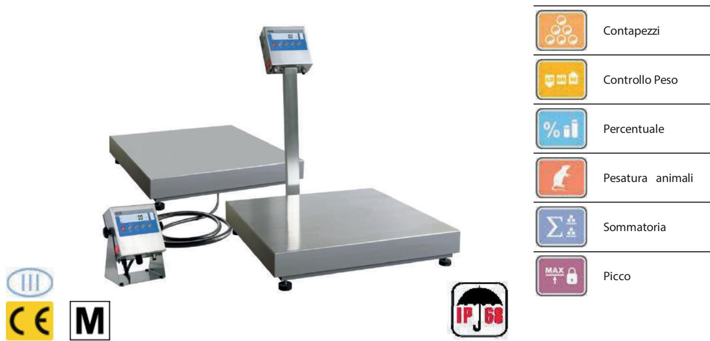
Le bilance WPT H sono progettate con il 100% di protezione all'acqua per la cella di carico. Questa soluzione protegge la cella di carico da agenti esterni. Tutti gli elementi della piattaforma sono in acciaio inox. L'indicatore di peso PUE C/31H viene installato su di una colonna oppure lasciato con 3 metri di cavo sciolto (/K).
