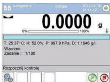
Il modulo THB2 è uno strumento di misura cooperante con la nuova serie di comparatori di massa e bilance da laboratorio 3Y. Le condizioni ambientali sono richiamate premendo un tasto apposito sullo schermo della bilancia.
