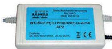
Modulo per uscita analogica 4/20mA progettato per la conversione del segnale digitale della lettura del peso in uno analogico. E' un modulo passivo, ovvero necessita di un'alimentazione esterna 24VDC. Il modulo power loop può differenziare le informazioni in uscita:
