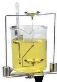
Ideato per bilance analitiche e da laboratorio con piatto tondo da  $\varnothing 85$  e  $\varnothing 100$  (KIT 85), quadrato da  $128 \times 128$  mm (KIT 128) oppure da  $195 \times 195$  mm (KIT195). Componenti in acciaio inox.
