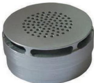
Set utilizzato per la determinazione della permeabilità al vapore acqueo su diversi materiali: vestiti, tessuti, o pelle. La permeabilità al vapore è una caratteristica che determina direttamente la qualità. Se sono prodotti con materiali scadenti, con una permeabilità eccessiva, potrebbero diventare "scomodi" all'uso. Utilizzando questo set in combinata con un analizzatore di umidità della serie MA.R o MA.3Y il calcolo viene ridotto notevolmente, da 72 ore a solo 50 minuti.
