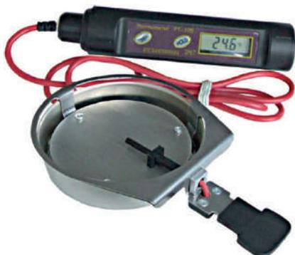
Ideato per gli analizzatori di umidità. Permette la rilevazione della temperatura con un sensore posto sul cavo. Caratterizzato inoltre dalla protezione all'acqua e dalla funzione di spegnimento automatico, prevenendo la scarica delle batterie. Alimentato da 3 x 1.5V (LR44).
