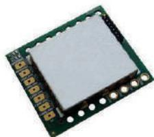
Il Modulo DP-2 è progettato per incrementare la versatilità dell'indicatore PUE 7. Applicando il modulo DP-2 è possibile connettere una seconda piattaforma addizionale ad una bilancia. Modulo che viene installato all'interno dell'indicatore.
